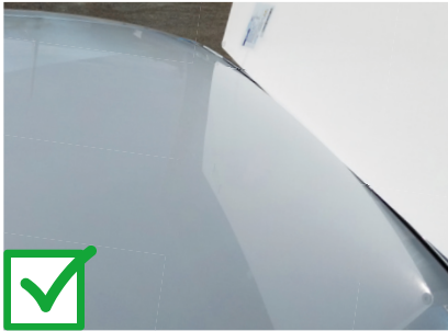
Güneş paneli montaj yüzeyinin temiz olması önerilir.
