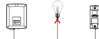
**Falsche Verbindung zwischen Verbraucher und Wechselrichter**
