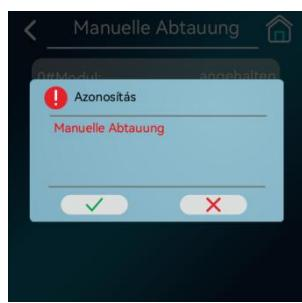
Nur wenn das Modul in Betrieb ist und die erforderliche Wassertemperatur, Lamellentemperatur und alle weiteren Bedingungen erfüllt sind, kann der Abtauvorgang durch Drücken der entsprechenden Taste erfolgreich gestartet werden. In diesem Fall wechselt das Modul in den Modus "Geräteabtauung". Andernfalls behält die Wärmepumpe ihren ursprünglichen Zustand bei.
