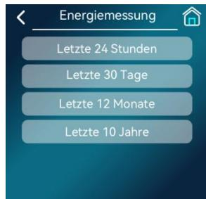
Die Bedienung der Steuereinheit zur Überprüfung von Leistung, Kapazität und COP (EER)-Wert in einem beliebigen Zeitraum ist gleich. Wir werden Ihnen den Vorgang beispielhaft für die letzten 30 Tage zeigen:
