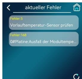
Durch Drücken der Fehlermeldung wird die genaue Bedeutung des Fehlercodes angezeigt.
