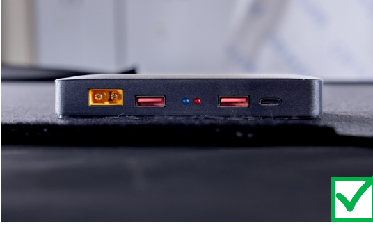
Panel üzerindeki bağlantı kutusunun çıkışları:XT60/USB X2-TYPE-C
