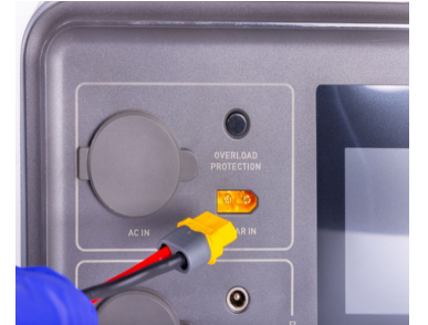
Dönüştürücüyü kullanırken güç kaynağında doğru yuvaya bağlandığından emin olun.
