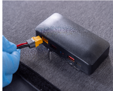
XT60 kablosunun panel üzerindeki bağlantı kutusuna takılması
