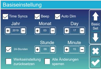
Werkseinstellung: Setzt alle Parameter des Wechselrichters zurück.
