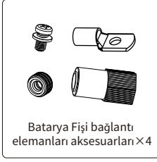
DC+/DC- fiş konektörleri, metal terminal dahil xN
