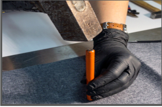
Montaj Aparatının Takılacağı Bölgenin İşaretlenmesi
