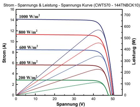
\* Die Spezifikationen wurden unter den Standardtestbedingungen (STC) gemessen: 1000 W/m<sup>2</sup> Sonneneinstrahlung, 1,5 Luftmasse und 25°C Zelltemperatur. Die Messunsicherheit für alle Panels beträgt 3%. Die tatsächlichen Parameter unterliegen den individuellen Verträgen. Diese Parameter dienen nur als Referenz und sind nicht Bestandteil der Verträge. Die technischen Spezifikationen in diesem Dokument können variieren. Weitere Informationen finden Sie in der "Installationsanleitung".
