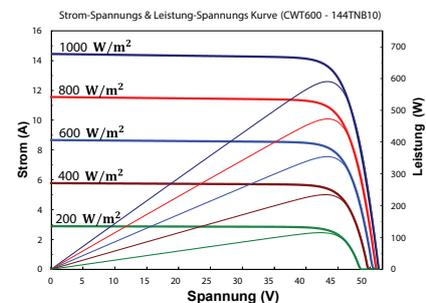
\* Die Spezifikationen wurden unter den Standardtestbedingungen (STC) gemessen: 1000 W/m<sup>2</sup> Sonneneinstrahlung, 1,5 Luftmasse und 25°C Zelltemperatur. Die Messunsicherheit für alle Panels beträgt 3%. Die tatsächlichen Parameter unterliegen den individuellen Verträgen. Diese Parameter dienen nur als Referenz und sind nicht Bestandteil der Verträge. Die technischen Spezifikationen in diesem Dokument können variieren. Weitere Informationen finden Sie in der "Installationsanleitung".
