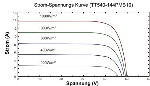
\* Die Spezifikationen wurden unter den Standardtestbedingungen (STC) gemessen: 1000 W/m<sup>2</sup> Sonneneinstrahlung, 1,5 Luftmasse und 25°C Zelltemperatur. Die Messunsicherheit für alle Panels beträgt 6%. Die tatsächlichen Parameter unterliegen den individuellen Verträgen. Diese Parameter dienen nur als Referenz und sind nicht Bestandteil der Verträge. Die technischen Spezifikationen in diesem Dokument können variieren. Weitere Informationen finden Sie in der "Installationsanleitung".
