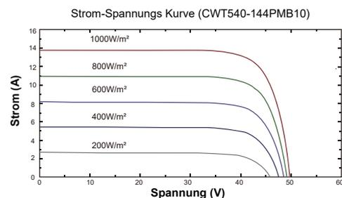
\* Die Spezifikationen wurden unter den Standardtestbedingungen (STC) gemessen: 1000 W/m<sup>2</sup> Sonneneinstrahlung, 1,5 Luftmasse und 25°C Zelltemperatur. Die Messunsicherheit für alle Panels beträgt 3%. Die tatsächlichen Parameter unterliegen den individuellen Verträgen. Diese Parameter dienen nur als Referenz und sind nicht Bestandteil der Verträge. Die technischen Spezifikationen in diesem Dokument können variieren. Weitere Informationen finden Sie in der "Installationsanleitung".
