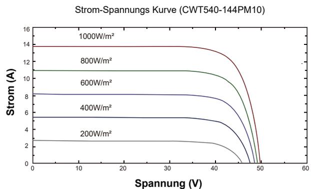
\* Die Spezifikationen wurden unter den Standardtestbedingungen (STC) gemessen: 1000 W/m<sup>2</sup> Sonneneinstrahlung, 1,5 Luftmasse und 25°C Zelltemperatur. Die Messunsicherheit für alle Panels beträgt 3%. Die tatsächlichen Parameter unterliegen den individuellen Verträgen. Diese Parameter dienen nur als Referenz und sind nicht Bestandteil der Verträge. Die technischen Spezifikationen in diesem Dokument können variieren. Weitere Informationen finden Sie in der "Installationsanleitung".
