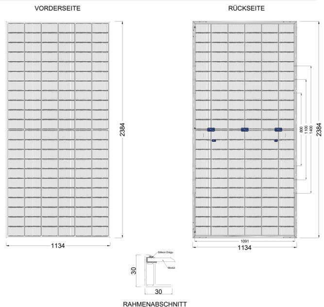
\* Die Spezifikationen wurden unter den Standardtestbedingungen (STC) gemessen: 1000 W/m<sup>2</sup> Sonneneinstrahlung, 1,5 Luftmasse und 25°C Zelltemperatur. Die Messunsicherheit für alle Panels beträgt 6%. Die tatsächlichen Parameter unterliegen den individuellen Verträgen. Diese Parameter dienen nur als Referenz und sind nicht Bestandteil der Verträge. Die technischen Spezifikationen in diesem Dokument können variieren. Weitere Informationen finden Sie in der "Installationsanleitung".
