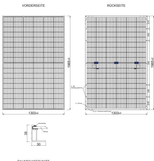
\* Die Spezifikationen wurden unter den Standardtestbedingungen (STC) gemessen: 1000 W/m<sup>2</sup> Sonneneneinstrahlung, 1,5 Luftmasse und 25°C Zelltemperatur. Die Messunsicherheit für alle Panels beträgt 3%. Die tatsächlichen Parameter unterliegen den individuellen Verträgen. Diese Parameter dienen nur als Referenz und sind nicht Bestandteil der Verträge. Die technischen Spezifikationen in diesem Dokument können variieren. Weitere Informationen finden Sie in der "Installationsanleitung".
