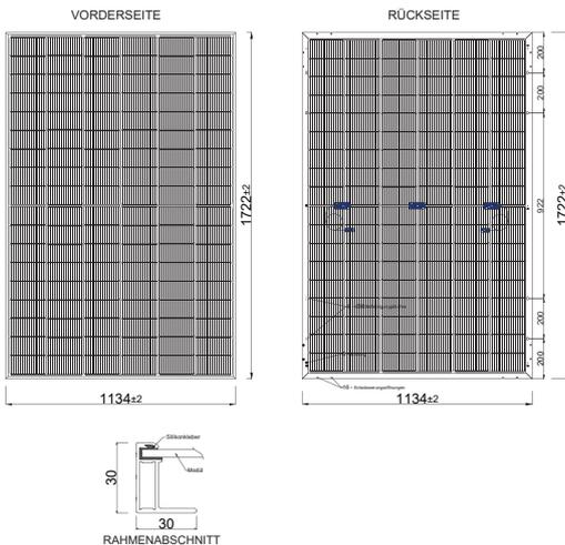
\* Die Spezifikationen wurden unter den Standardtestbedingungen (STC) gemessen: 1000 W/m<sup>2</sup> Sonneneinstrahlung, 1,5 Luftmasse und 25°C Zelltemperatur. Die Messunsicherheit für alle Panels beträgt 3%. Die tatsächlichen Parameter unterliegen den individuellen Verträgen. Diese Parameter dienen nur als Referenz und sind nicht Bestandteil der Verträge. Die technischen Spezifikationen in diesem Dokument können variieren. Weitere Informationen finden Sie in der "Installationsanleitung".
