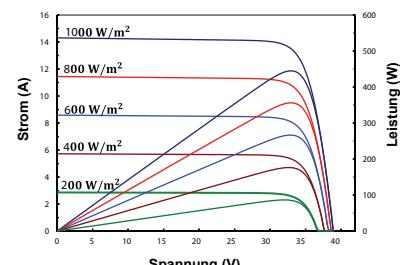
\* Die Spezifikationen wurden unter den Standardtestbedingungen (STC) gemessen: 1000 W/m<sup>2</sup> Sonneneinstrahlung, 1,5 Luftmasse und 25°C Zelltemperatur. Die Messunsicherheit für alle Panels beträgt ±3%. Die tatsächlichen Parameter unterliegen den individuellen Verträgen. Diese Parameter dienen nur als Referenz und sind nicht Bestandteil der Verträge. Die technischen Spezifikationen in diesem Dokument können variieren. Weitere Informationen finden Sie in der "Installationsanleitung".
