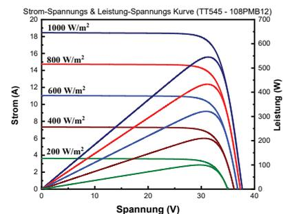
\* Die Spezifikationen wurden unter den Standardtestbedingungen (STC) gemessen: 1000 W/m<sup>2</sup> Sonneneinstrahlung, 1,5 Luftmasse und 25°C Zelltemperatur. Die Messunsicherheit für alle Panels beträgt 6%. Die tatsächlichen Parameter unterliegen den individuellen Verträgen. Diese Parameter dienen nur als Referenz und sind nicht Bestandteil der Verträge. Die technischen Spezifikationen in diesem Dokument können variieren. Weitere Informationen finden Sie in der "Installationsanleitung".
