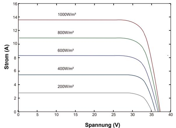
\* Die Spezifikationen wurden unter den Standardtestbedingungen (STC) gemessen: 1000 W/m<sup>2</sup> Sonneneinstrahlung, 1,5 Luftmasse und 25°C Zelltemperatur. Die Messunsicherheit für alle Panels beträgt 3%. Die tatsächlichen Parameter unterliegen den individuellen Verträgen. Diese Parameter dienen nur als Referenz und sind nicht Bestandteil der Verträge. Die technischen Spezifikationen in diesem Dokument können variieren. Weitere Informationen finden Sie in der "Installationsanleitung".
